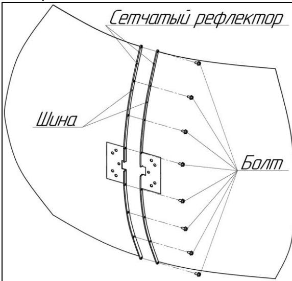
Схема 1 – Сборка сетчатого рефлектора антенны
