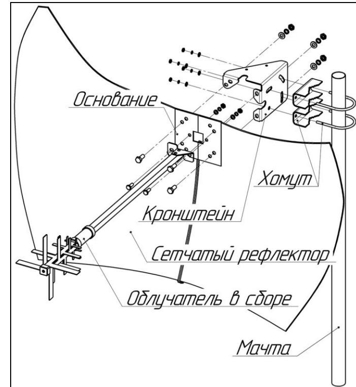
Схема 2 – Сборка сетчатой параболической антенны
