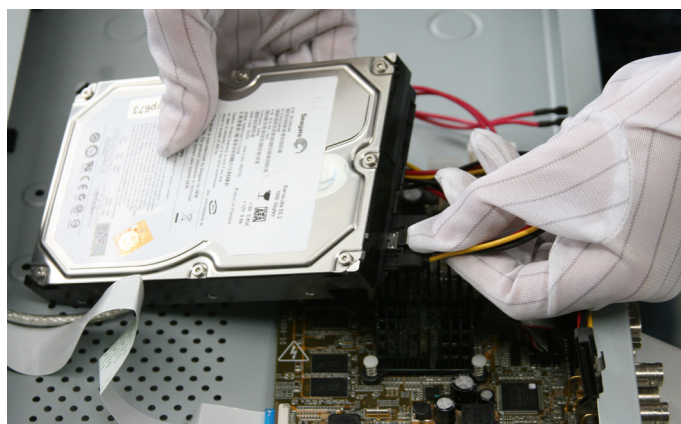
Рисунок 2.3 Подключение кабеля питания
