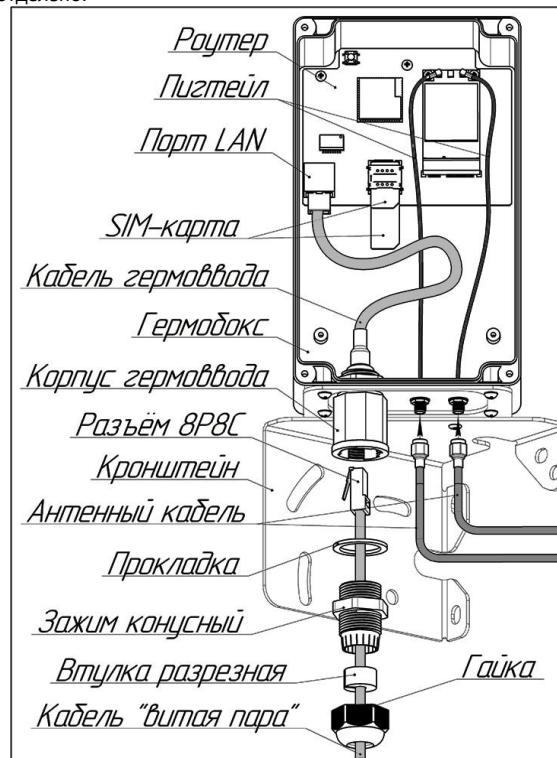
Схема 2 – Подключение UTP кабеля к гермовводу
