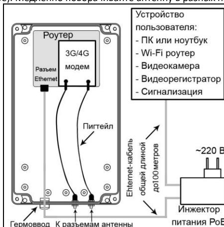
Схема 3 – Подключение PoE инжектора питания
