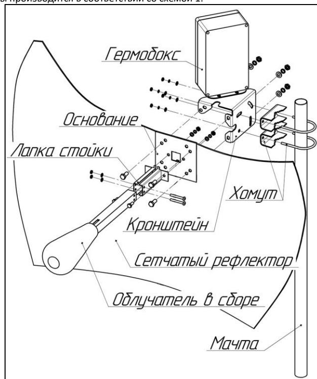
Схема 1 – Сборка антенны
